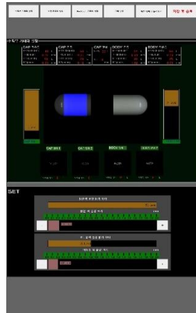
수직부 카메라 설정 (1, 9 번 카메라) – 외관 불량, 이물, 얼룩, 인쇄 불량, 컬러 불량 등을 검출
